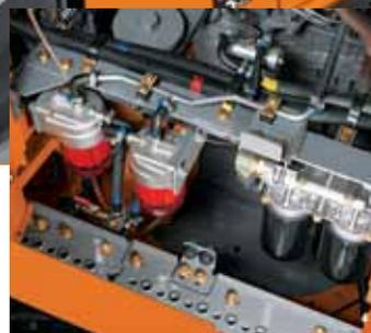
■ Los filtros verticales enroscables de combustible y de aceite del motor y el sistema hidráulico facilitan el mantenimiento y reducen la suciedad. Todos los filtros y puntos de verificación están agrupados convenientemente.
