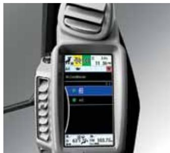
■ El control de climatización automática de dos niveles y alta velocidad cuenta con rejillas ajustables tipo automóvil. Permite mantener el cristal nítido y la cabina confortable.
