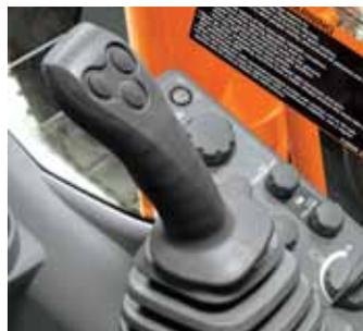
■ Las palancas piloto de cambio rápido son ergonómicas y permiten un control perfecto y preciso con menos movimiento y esfuerzo. Si las condiciones de excavación se tornan más exigentes, el operador puede hacerle frente con solo pulsar el botón de refuerzo de potencia.
