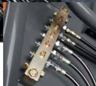
■ Los conjuntos de lubricación centralizados contienen engrasadores Zerk a los que se accede muy fácilmente y que permiten engrasar la máquina de manera más limpia y rápida.
