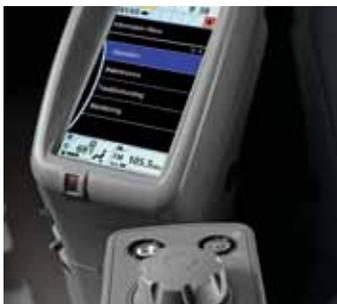
■ El monitor LCD multilingüe y el cuadrante giratorio suministran una extensa variedad de datos y permiten controlar diferentes funciones. Sólo deberá girar y presionar el cuadrante para seleccionar modalidades de funcionamiento, monitorear intervalos de mantenimiento, verificar códigos de diagnóstico, fijar la temperatura de la cabina, sintonizar la radio, hacer ajustes hidráulicos simples de los accesorios y mucho más.
