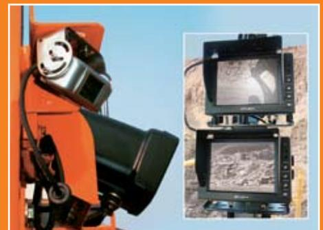
■ Mediante cámaras de accionamiento remoto, el operador elimina virtualmente los puntos ciegos.
