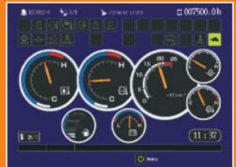
■ El monitor LCD de 10,5 pulgadas presenta información relacionada con el funcionamiento y los códigos de fallo de la máquina.
