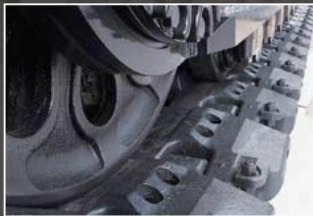
■ **ESLABONES CON GUÍAS:** El tren de rodaje del modelo EX1900-6 es semejante al de los tractores. La EX2500-6 y los modelos más grandes tienen trenes de rodaje semejantes al de las palas, con zapatas de fundición y rodillos guías.
