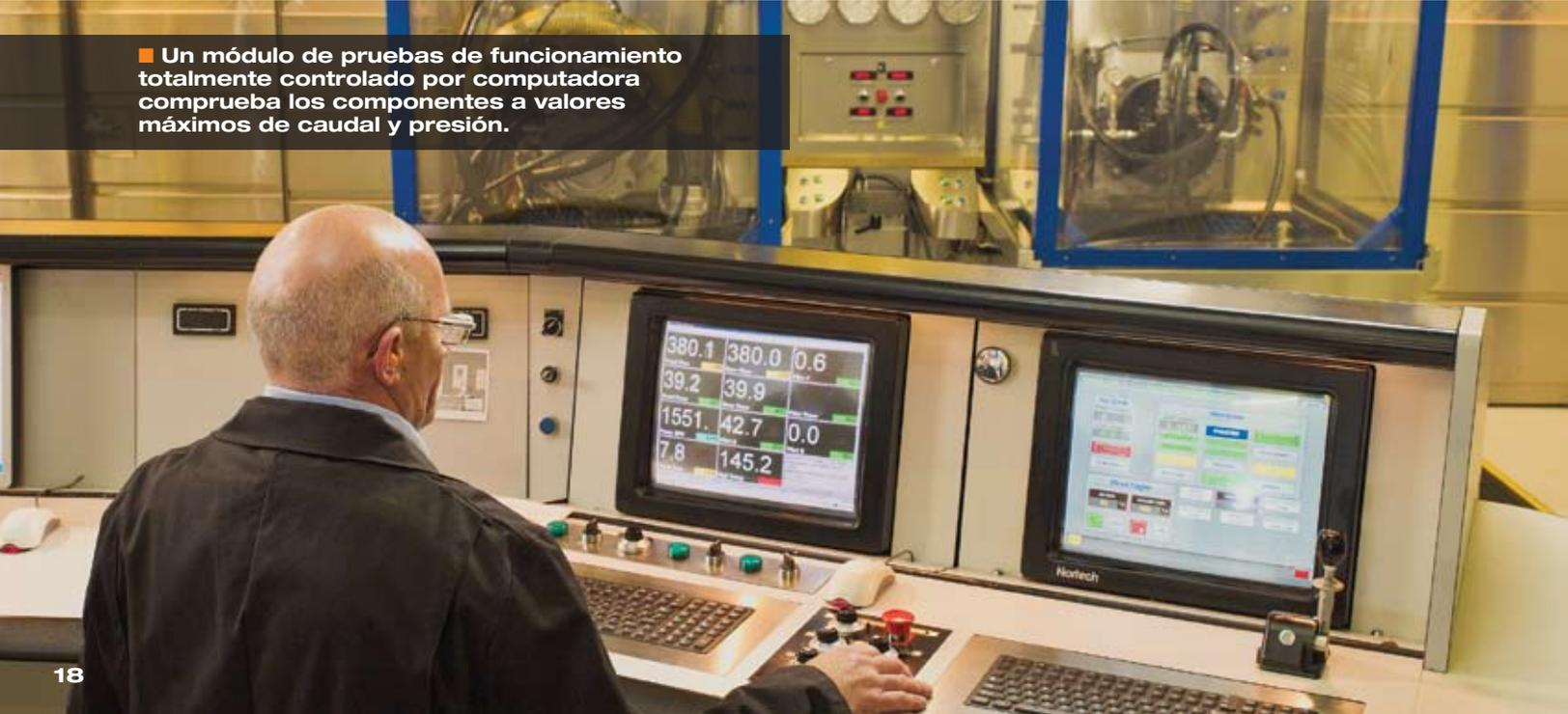
■ Un módulo de pruebas de funcionamiento totalmente controlado por computadora comprueba los componentes a valores máximos de caudal y presión.
