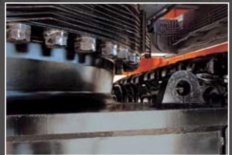
■ **CHASIS DE ORUGA MÁS SÓLIDO:** El sólido soporte de base forjado del cojinete del mecanismo de giro situado en el chasis de oruga central ofrece una confiabilidad mayor, característica exclusiva de Hitachi.
