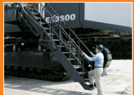
■ En la EX2500-6 y los modelos más grandes, las escaleras se pliegan hidráulicamente; en la EX1900-6, es una prestación opcional.
