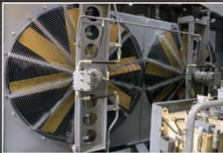
■ **ENFRIADORES DE ACEITE HIDRÁULICO:** Se han separado de los radiadores para mejorar el equilibrio térmico. Para enfriar el aceite hidráulico, se utilizan ventiladores de accionamiento hidráulico. La temperatura del aceite regula los ventiladores, para optimizar el enfriamiento y la eficiencia.
